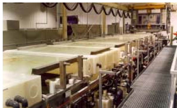
Abb. 13: Deckel am Behälter, durch Transportwagen betätigt, Bild: Stohrer GmbH
