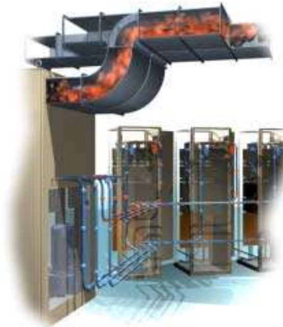
Abb. 10: Verlustwärmenutzung von Gleichrichtern durch Wasser-Luft-Wärmetauscher im Zuluftstrom
