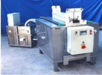
Abb. 21: Umlufttrockner nach Tscherswitschke, Bild: Richard Tscherswitschke GmbH
