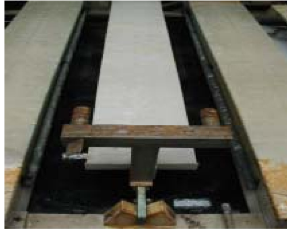
Abb. 14: Teilabdeckung am Gestellträger (Draufsicht), Bild: Thoma Metallveredelung GmbH
